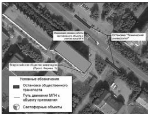
Рисунок 3.19.8 – Предлагаемая схема организации безопасных и комфортных подходов для МГН (остановка «Технический университет»)
