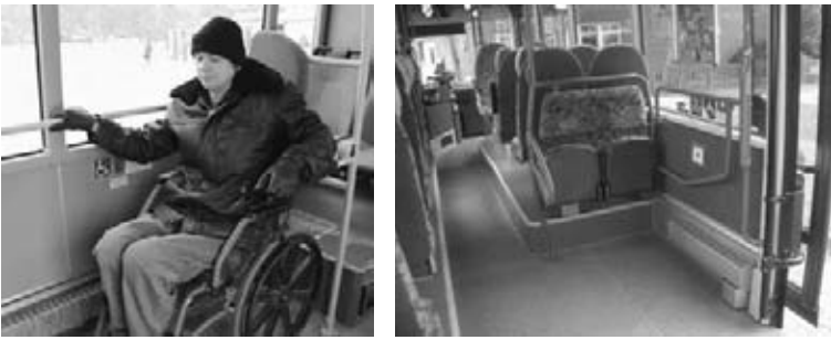
Рисунок 3.19.11 – Оборудование подвижного состава для комфортного перемещения МГН
