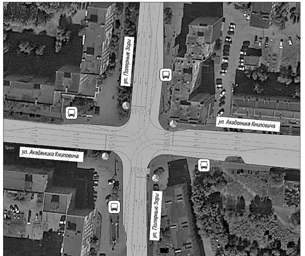
Рисунок 3.2.4 – Предлагаемая схема ОДД на пересечении ул. Академика Книповича – ул. Полярные Зори
