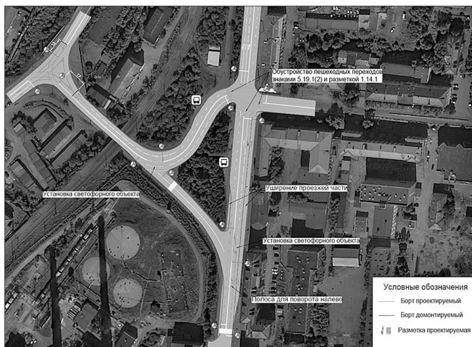
Рисунок 3.2.1 – Предлагаемая схема ОДД на пересечении ул. Шмидта – ул. Академика Книповича
