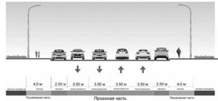
Рисунок 3.7.2 – Поперечный профиль улицы с предлагаемой схемой организации парковочного пространства
